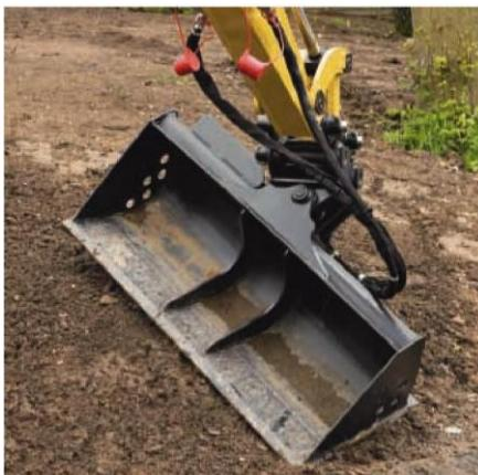
**Ángulo del Cucharón.** El ángulo del cucharón de alta rotación combina una buena retención de material con un zanjado posterior parejo.
