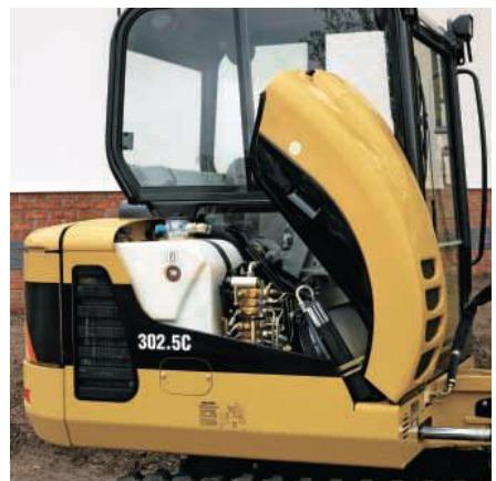
**La Cubierta Lateral se levanta.** Cuenta con un conveniente acceso a las válvulas del implemento y al tanque hidráulico a través de su cubierta lateral que se levanta.
