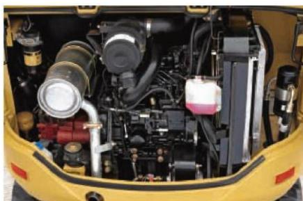
**Acceso para Mantenimiento.** Sus grandes puertas posteriores que se abren hacia afuera permiten acceder a los componentes principales y puntos de servicio dentro del compartimento del motor, incluyendo:
