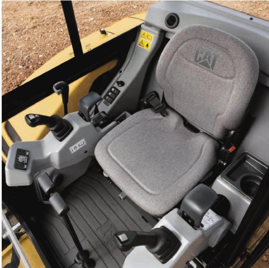
**Estación del Operador** Su cabina grande y espaciosa ofrece un mayor espacio para las piernas, con mejor circulación de aire y una amplia visibilidad del área con un vidrio plano por toda la cabina para un fácil reemplazo sin mayor costo.
