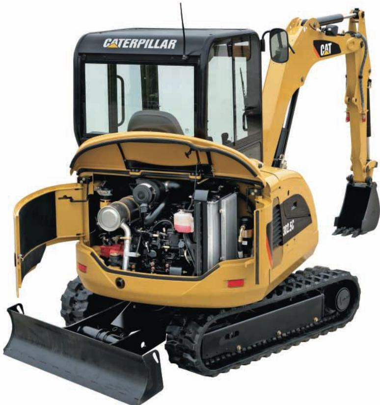
**Varillaje Delantero.** Sus líneas protegidas de varillaje delantero pasan por encima de la pluma y el brazo de modo que los lados se mantienen limpios ayudando así a reducir el daño y el tiempo de parada.
