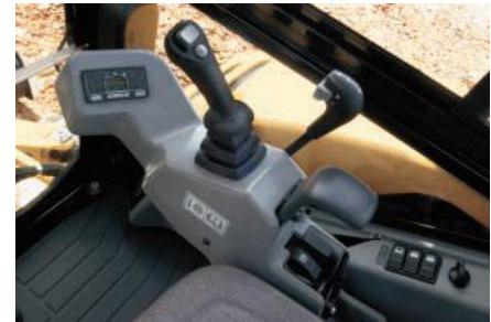
**Controles de Poco Esfuerzo.** Sus controles ergonómicos de bajo esfuerzo brindan mayor comodidad para una mayor productividad. El control de desplazamiento de dos velocidades montado en la palanca de la hoja permite una fácil operación con un mayor espacio para los pies.
