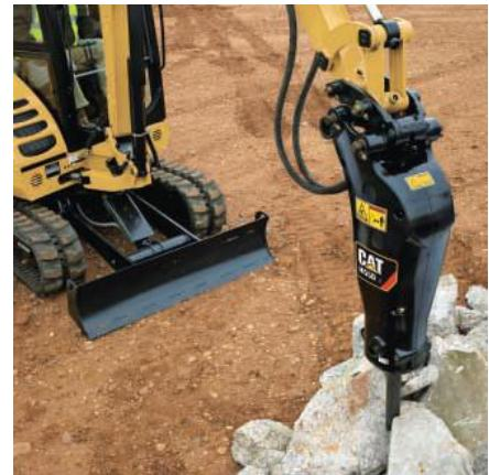
**Conectores y Líneas Auxiliares.** Los conectores y líneas auxiliares se ofrecen como estándar, lo que significa que la Cat 302.5 viene lista para operar, tanto para operación con herramienta de martillo (una vía) como de sifón (dos vías).
