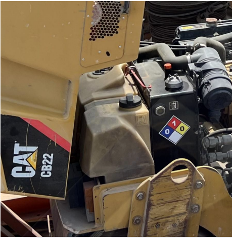
Tanque de combustible
